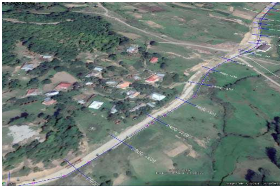
Figurë 17: Objektet e banimit ne km 9+450 deri ne km 9+600( distanca me objektin me prane aksit te rruges 25 m )
